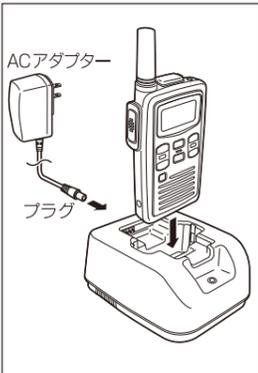
**注意** ●指定以外のバッテリーパック、充電器、ACアダプターを使用しないでください。火災、破裂、発熱、感電、けが、故障の原因となります。
