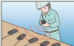
ACSH(アクシュ)モードは他社製でも、別機種でも中継設定でも関係なく、今お使いのチャンネルとグループ番号を受信して検知、自動設定した後、キーロックまでかけてくれます。エアクローン機能はセットモードまで含めた全ての設定をまるごと全部、一度に無線で他の同じ機種の無線機にコピーできます。(エアクローンは同機種間でのみ動作します。)
