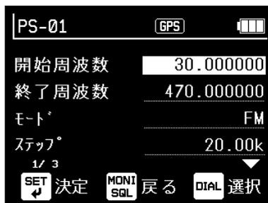
**重要** 操作中に [MONI] キーを押すことで、プログラムチャンネル選択画面 (PROG 画面) まで戻ってしまうと作業した内容が全て消えて、やり直しになります。この無駄を避けるため、ここまでの操作が終了したら [上ダイヤル] を回して最後のメニュー「書込」を [SET] キーで選択、「書き込みしますか？」画面で [上ダイヤル] を回して「はい」を選び [SET] キーで確定、保存することをお勧めします。PROG 画面で編集中のプログラムチャンネルを選択すると、続けて操作ができます。
