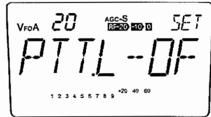
2. メインダイヤルを時計回りに回し [PTT. L-ON] を選ぶと受信専用機として使えます。
