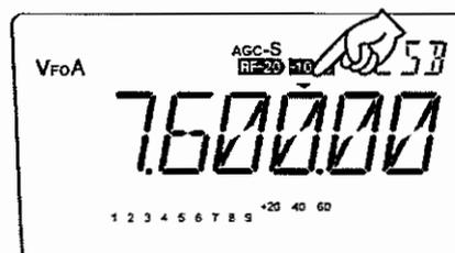
4. [▼] キーを押し続け、10 kHz 台、1 kHz 台に 70 を表示させます。3 秒以上押し続けるとステップが高速になります。7.670.00 の表示に合わせます。
