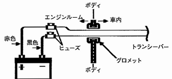
注： 配線穴を通すときには、グローメットを使い、ボディの切り口が電源コードに直接触れないようにしてください。
