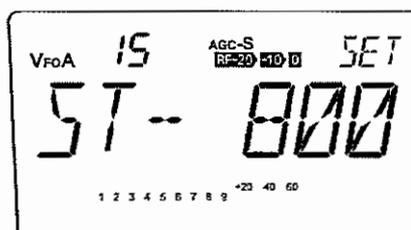
2. ダイヤルを回すとディスプレイとサイドトーンが 50 Hz ステップで切り換わります。
