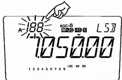
4. FUNC とディスプレイに表示が出ている状態で [V/M] キーを 1 秒以上長く押すとピーと音がして点滅していた番号が消え、メモリー登録が完了して VFO モードに戻ります。
