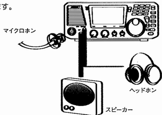
注： コネクタはしっかり締め付け、時々接続部を確認してください。接続がゆるいと送信音声にノイズが発生することがあります。
