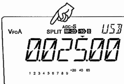
3. [FUNC] キーを押し、[7] キーを押します。オフセットのシフト幅設定状態になります。[▲/▼] キーを押すかダイヤルを使って「+0.025.00」を選択します。[M/KHz] キー、[▲/▼] キー以外のキーを押します。ピーと音が出ます。
