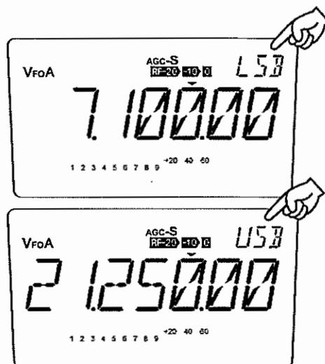
注： 本機のスケルチ回路は S メーターレベルによって動作していますので、SSB モードで AGC-F モードが選択されている場合、信号の強さによってはスケルチがかかることがあります。AGC-F ではなく AGC-S モードの使用をお勧めします。
