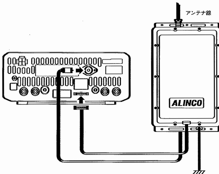
注意： EDX-2 の出力端子はロングワイヤーアンテナ、もしくは接地型のホイップアンテナにのみ接続することができます。同軸ケーブルを使用するアンテナはお使いになれません。詳細は EDX-2 の取扱説明書に記載されていますので必ずお読みください。
