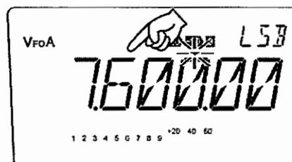
3. 再度 M/KHz キーを押してカーソルの点滅を止めます。
