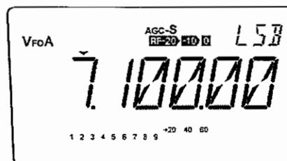
▼マークが 1 kHz 桁の数字の上で点滅しているときは
