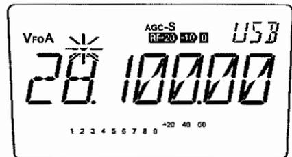
6. 1 kHz 桁の上に点滅する▼マークが出るまで [M/KHz] キーを繰り返し押します。
