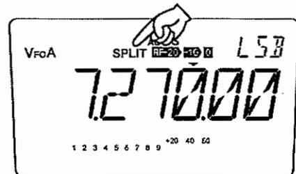
4. [FUNC] キーを押し、[5] キーを押します。SPLIT アイコンがディスプレイに表示されます。
