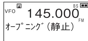
**3 ダイヤル(左下)を回して、オープニング文字の「スライド」・「静止」・「無効」のどれかを選択します。****4 ダイヤル(右下)を回すと文字入力のカーソルを移動できます。****5 文字入力方法はメモリーネームの入力方法([P42](#))の手順をご参照ください。**
