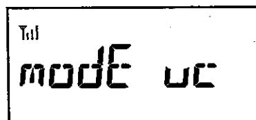
⑥「MODE」キーを押すことでチャンネルだけの表示とチャンネルとコードの表示とを切替できます。
