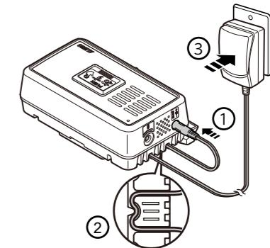
\*L字変換ケーブルをご使用になると、ケーブルを這わせやすい場合があります。また、ACアダプターだけではコンセントまでの長さが足りないときにもご使用いただけます。取付方法は本体の電源端子とL字変換ケーブルのプラグを接続した後、L字変換ケーブルのソケットとACアダプターのプラグを接続してください。
