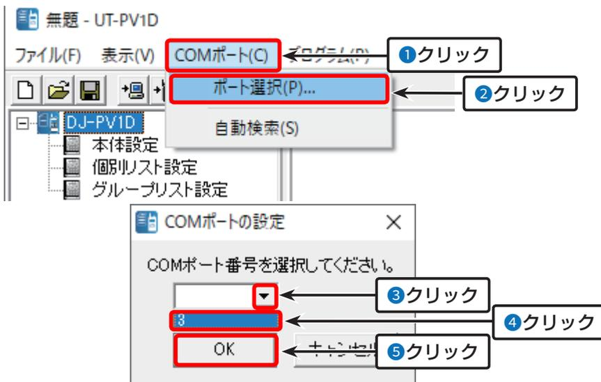
※自動で設定するときは、無線機とパソコンを接続(P.5)して、無線機の電源を入れた状態で、下記のように操作してください。
