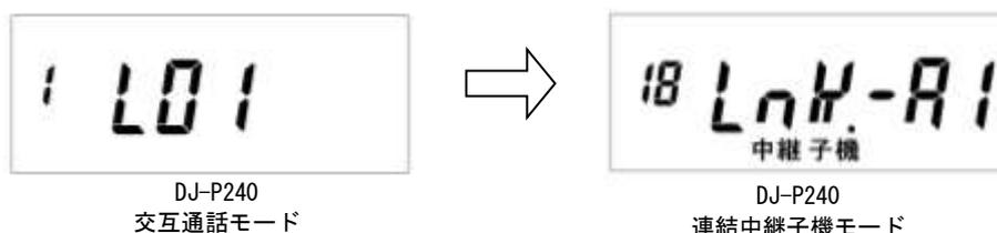
参考：交互通話や中継子機モードに戻りたいときは、ファンクションキーを押した後でモードキーを押して、ダイヤルを回して通話モードを選び、PTTキーを押して確定します。(DJ-P240 取扱説明書 P.27 参照) 連結中継子機モードに戻る時も同じ操作をしてください。簡易リセットはこのモードも含めて設定内容を初期化できます。完全リセットをすると、連結中継子機モードはモード切り替えでは出てこなくなります。改めて上記の操作を繰り返してください。(リセットの詳細は説明書 P.45, 46 参照)
