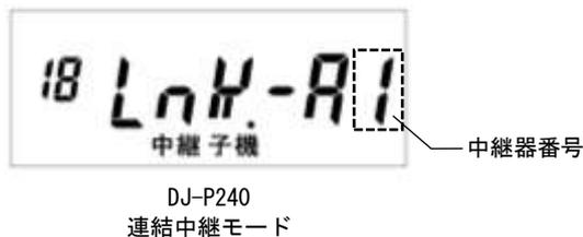
参考：2 台目以降、連結する台数分の中継器番号を「2」~「4」に切り替えて同じ操作をします。2 台目は「2」、3 台目は「3」四台目は「4」にします。この番号は設置の時も重要になるので、目印を付けるなどして間違えないようにしてください。
