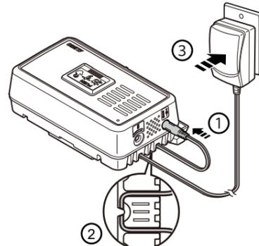
※L字変換ケーブルをご使用になると、ケーブルを這わせやすい場合があります。また、ACアダプターだけではコンセントまでの長さが足りないときにもご使用いただけます。取付方法は本体の電源端子とL字変換ケーブルのプラグを接続した後、L字変換ケーブルのソケットとACアダプターのプラグを接続してください。
