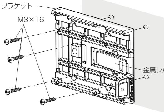
**注意** ネジは付属品、または壁の材質に合わせたネジを使用してください。ブラケットと壁の間に隙間がないように、しっかりと固定してください。定期的にネジにゆるみがないかまたは落下するおそれがないか点検してください。
